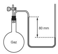
Puisqu'il s'agit d'un manomètre à bout ouvert, donc d'un instrument de mesure à pression relative, il faut tenir compte de la pression atmosphérique lorsqu'on détermine la pression d'un gaz.
