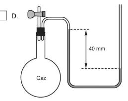
**5.** Si la pression atmosphérique est de 765 mm Hg, quelle est la pression indiquée par le manomètre illustré ci-contre ?
